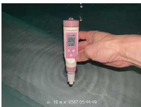
ภาพที่ 3.5.3-1 การตรวจวัดค่าความเป็นกรด-ด่าง และคลอรีน
